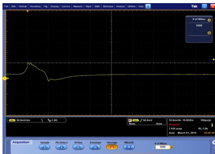
Рисунок 2 – Осциллограмма при минимальном значении коэффициента усиления
